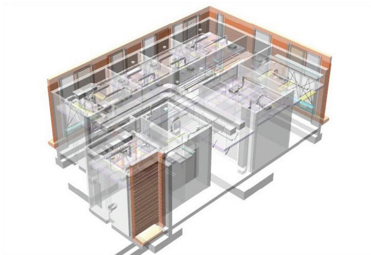
Abbildung 4.16: Beispiel einer BIM-Koordination zwischen Architektur und Haustechnik (Quelle: baum kappler architekten)
