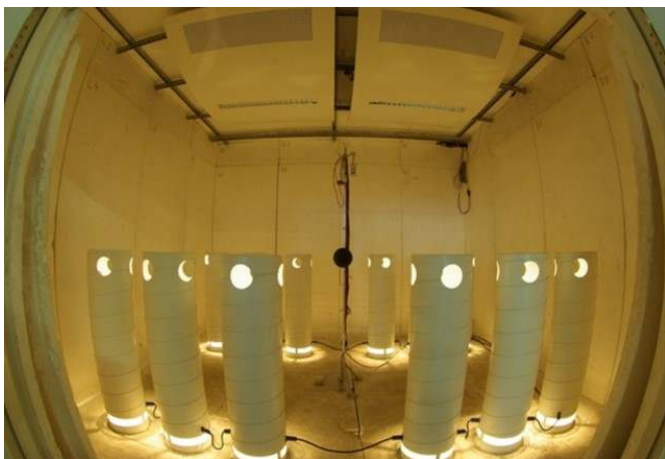
Einbausituation im Prüfraum gemäß DIN EN 14240
